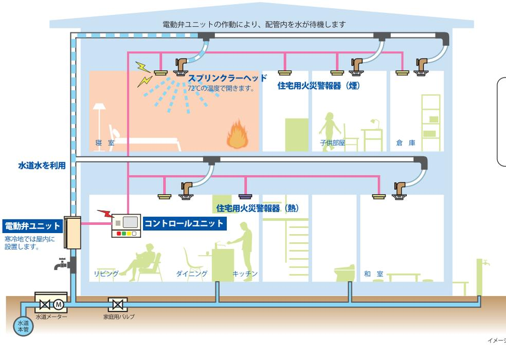
住宅用火災警報器と連動した住宅用スプリンクラーシステム。常時配管の中は水のない安心の乾式システムです。
